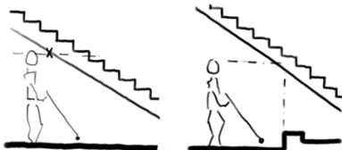
Abb.11: Un-Höhen vermeiden, kennzeichnen oder baulich verhindern z.b. durch eine Mauer.
